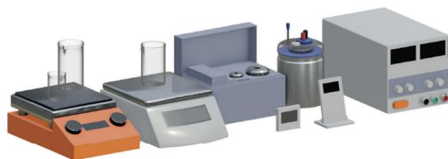
Установка предназначена для проведения лабораторных работ с задачей определения количества теплоты, отданное горячей водой и полученное холодной водой при теплообмене.
