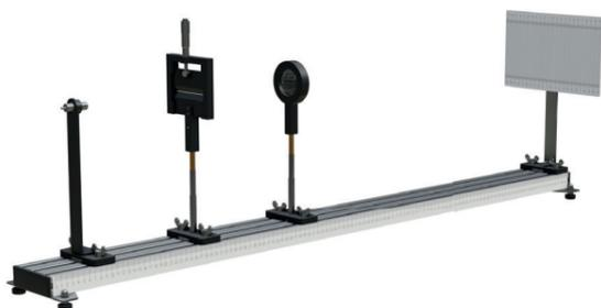
Установка предназначена для проведения лабораторных работ с задачей экспериментально продемонстрировать выполнение ограничений, накладываемых принципом неопределенности Гейзенберга.
