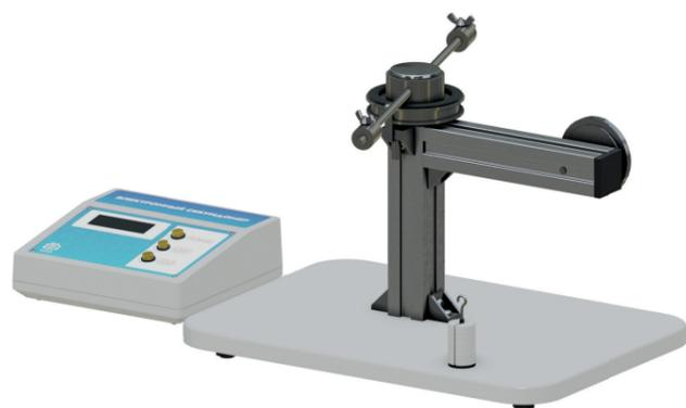
Лабораторная установка предназначена для экспериментального изучения уравнения движения Ньютона.
