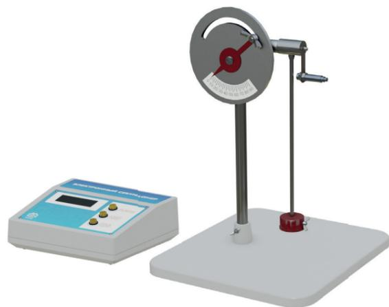
Лабораторная установка предназначена для экспериментального измерения зависимости периода колеблющегося маятника от эффективной составляющей ускорения свободного падения.
