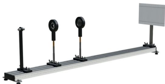
Установка предназначена для проведения лабораторных работ с задачей наблюдения явления дифракции света на дифракционных решетках.
