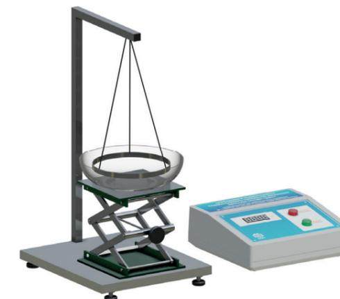
Установка предназначена для проведения лабораторных работ с задачей определения коэффициента поверхностного натяжения жидкости методом отрыва петли.
