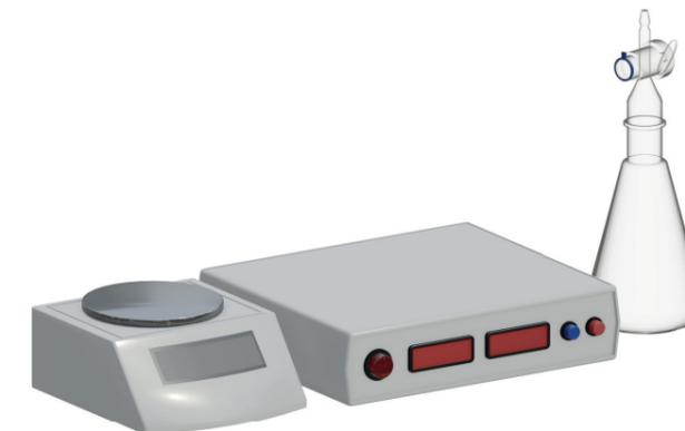
Установка предназначена для проведения лабораторных работ с задачей определения универсальной газовой постоянной.
