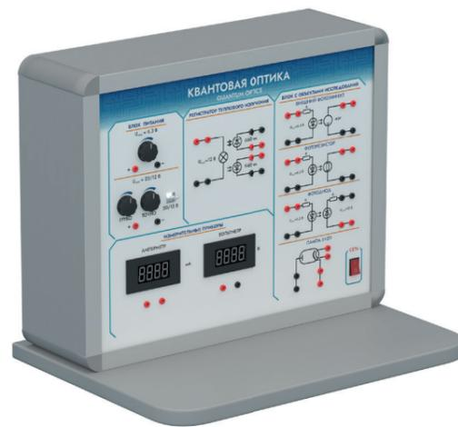
Установка предназначена для проведения лабораторных работ с задачей изучения внешнего фотоэффекта, работы фотодиода, работы фоторезистора, распределения электронов по скоростям при термоэлектронной эмиссии, контактной разности потенциалов, теплового излучения.
