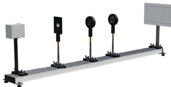
Установка предназначена для проведения лабораторных работ с задачей определения фокусного расстояния, собирающей и рассеивающей линз.
