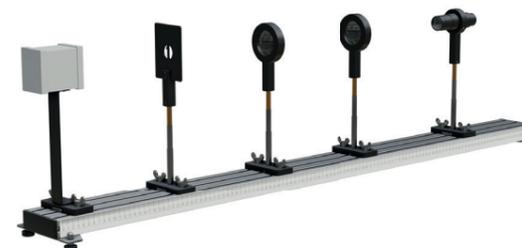
Установка предназначена для проведения лабораторных работ с задачами изучения и исследования модель микроскопа.
