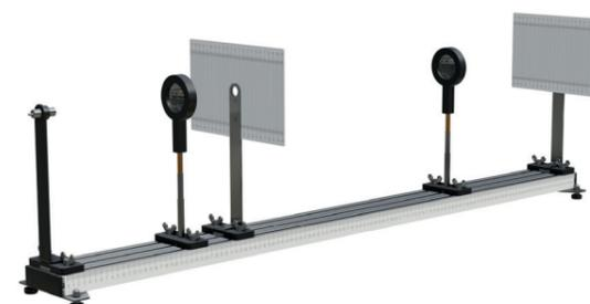
Установка предназначена для проведения лабораторных работ с задачей наблюдения интерференционной картины в отраженном свете.
