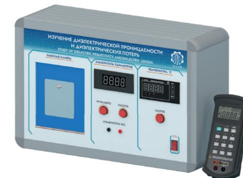
Установка предназначена для проведения лабораторных работ с задачей изучения основных электрофизических характеристик материалов: емкости, диэлектрической проницаемости, тангенса угла диэлектрических потерь твердых диэлектриков, и изучения этих характеристик в зависимости от температуры и частоты.
