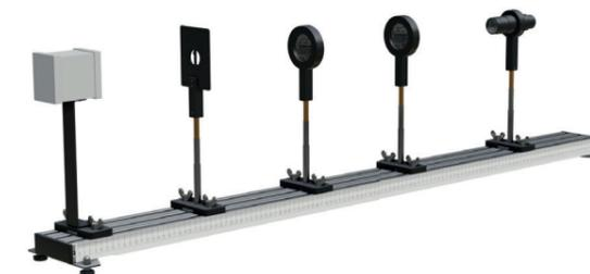
Установка предназначена для проведения лабораторных работ с задачей изучения моделей зрительной трубы.
