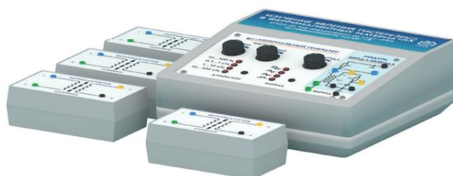
Установка предназначена для проведения лабораторных работ с задачей изучения магнитных свойств и основных параметров ферромагнетиков.
