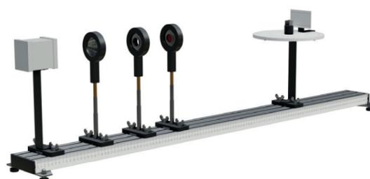
Установка предназначена для проведения лабораторных работ с задачей коэффициентов преломления вещества в зависимости от длины волны излучения.
