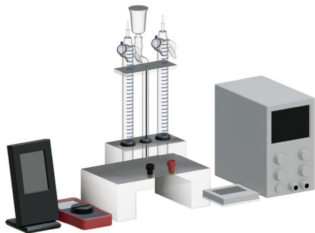
Установка предназначена для проведения лабораторных работ с задачей определения постоянной Фарадея путем измерения количества водорода и кислорода, образующегося в результате электролиза.
