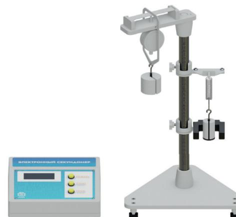
Лабораторная установка предназначена для изучения упругих деформаций пластины и пружины.
