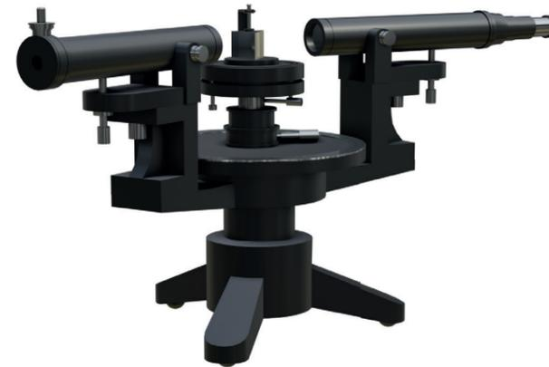
Установка предназначена для проведения лабораторных работ с задачей изучения дифракционной решетки и ознакомления принципов работы гониометра.
