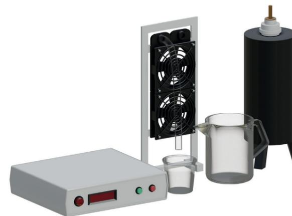
Установка предназначена для проведения лабораторных работ с задачами: определение удельной теплоты парообразования воды и изучение процесса кипения (испарения).
