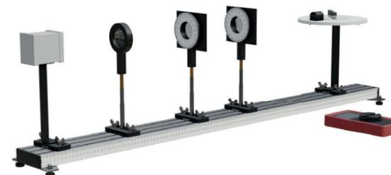
Установка предназначена для проведения лабораторных работ с задачей изучения явления поляризации света.
