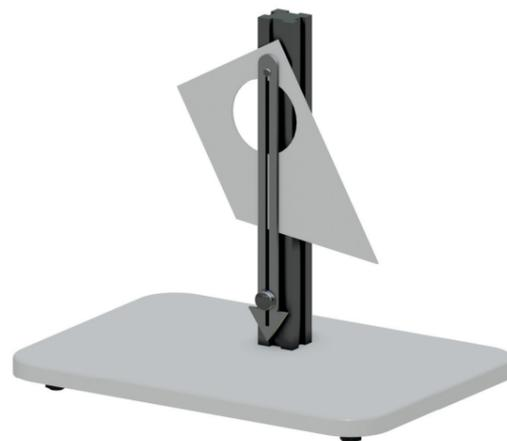
Лабораторная установка предназначена для экспериментального определения положения центра тяжести изучаемых образцов постоянной толщины и различной конфигурации.
