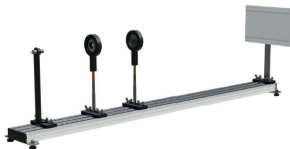
Установка предназначена для проведения лабораторных работ с задачей изучения явления интерференции с помощью бипризмы Френеля.
