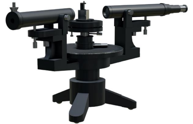
Установка предназначена для проведения лабораторных работ с задачей изучения явления дисперсии и ознакомления работы гониометра.
