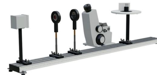
Установка предназначена для проведения лабораторных работ с задачей определения показателя преломления и дисперсии различных жидкостей, демонстрации разложения света в спектр при прохождении различных жидкостей.
