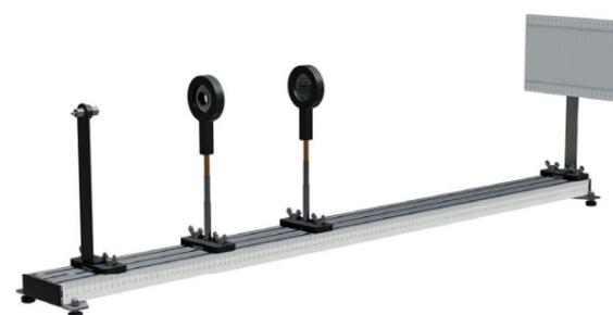
Установка предназначена для проведения лабораторных работ с задачей исследования явление дифракции с помощью двойной щели.
