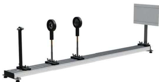
Установка предназначена для проведения лабораторных работ с задачей наблюдения явления дифракции света на простейших объектах (круглом отверстии и круглом диске).
