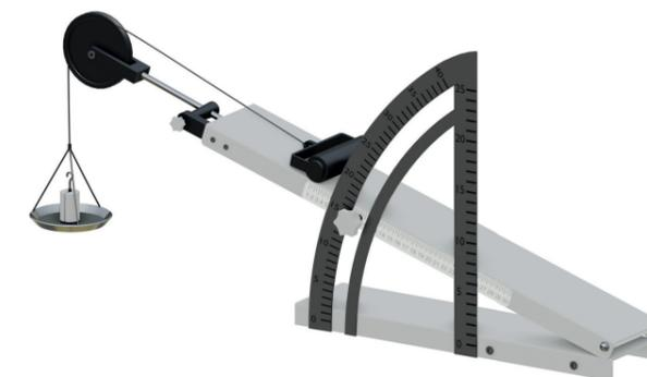
Лабораторная установка предназначена для экспериментального определения коэффициентов трения покоя, скольжения и качения и определение силы реакции опоры на тело.
