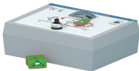
Установка предназначена для проведения лабораторных работ с задачей определения сопротивлений с помощью мостовой схемы Уитстона
