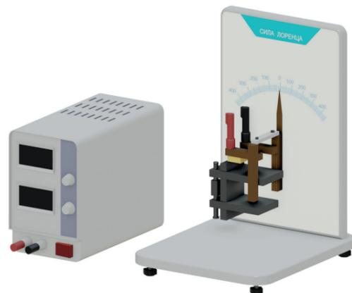
Установка предназначена для проведения лабораторных работ с задачей определения силы, действующей на проводник с током в магнитном поле.
