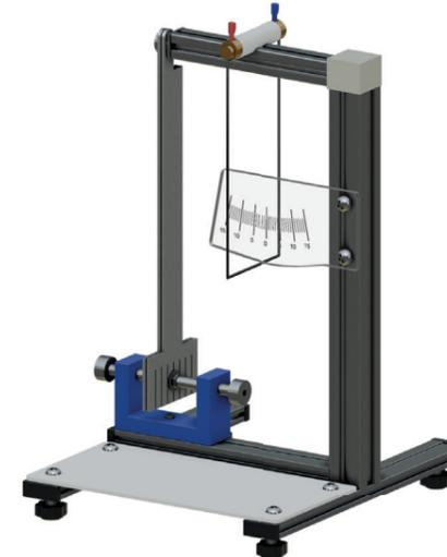
Установка предназначена для проведения лабораторных работ с задачей проведения работ по изучению силы, действующей на проводник с током в магнитном поле.
