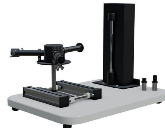
Установка предназначена для проведения лабораторных работ с задачей наблюдения спектральных линий инертных газов и паров металлов и измерения длины волны спектральных линий при помощи призматического спектрографа.
