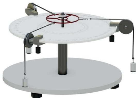
Лабораторная установка предназначена для экспериментального исследования векторного сложения сил.
