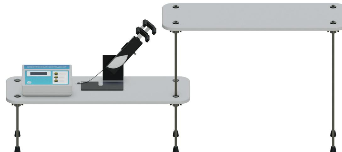
Лабораторная установка предназначена для определения зависимости между дальностью полета, высотой, углом вылета и начальной скоростью.
