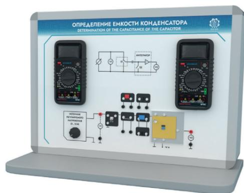
Установка предназначена для проведения лабораторных работ с задачами изучения методов измерения электрической емкости конденсатора; экспериментальной проверки формул для расчета емкости батареи конденсаторов при их параллельном и последовательном соединениях.
