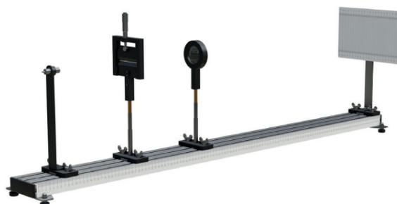
Установка предназначена для проведения лабораторных работ с задачей исследования явления дифракции на одной щели.
