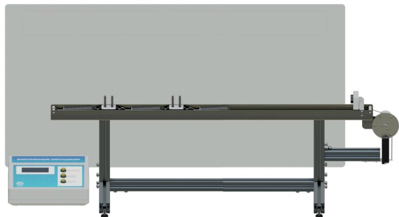
Лабораторная установка предназначена для изучения свободных и вынужденных механических колебаний под действием силы упругости, что включает измерение частоты внешнего воздействия на систему, определение амплитуды и частоты колебаний, построение резонансной кривой, определение резонансной частоты системы и ее добротности.
