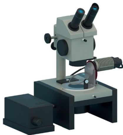
Установка предназначена для проведения лабораторных работ в вузе с задачей изучения интерференционной схемы колец Ньютона.
