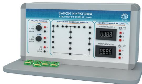
Установка предназначена для проведения лабораторных работ с задачей изучения законов Кирхгофа.
