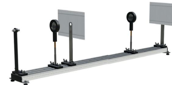
Установка предназначена для проведения лабораторных работ с задачей определению показателя преломления стеклянной пластины.
