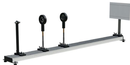
Установка предназначена для проведения лабораторных работ с задачей изучения интерференции света с помощью экрана Юнга.
