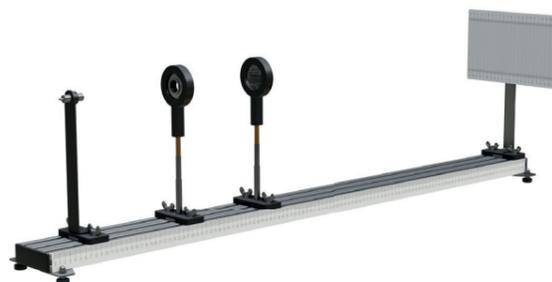
Установка предназначена для проведения лабораторных работ с задачей наблюдения явления дифракции света на простейших объектах и дифракционных решетках.
