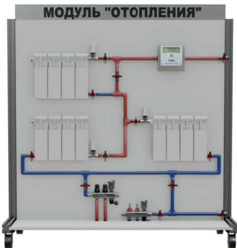
Модуль предназначен для демонстрации особенностей монтажа обвязки отопительных приборов и водяного теплого пола в системах отопления.
