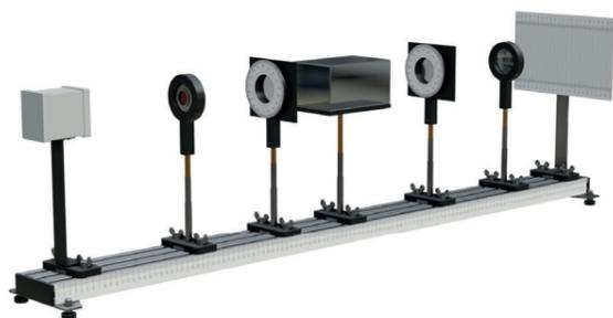
Установка предназначена для проведения лабораторных работ с задачей изучения оптической активности и определения концентрации сахара в растворе.
