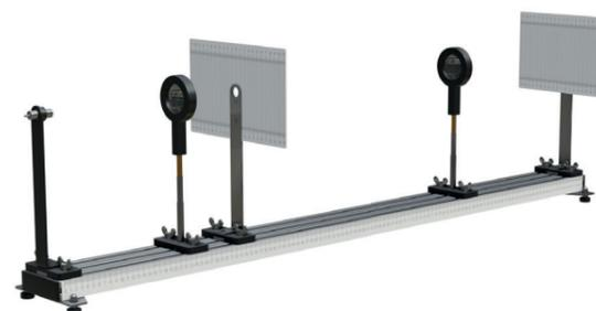
Установка предназначена для проведения лабораторных работ с задачей изучения интерференции света методами деления волнового фронта (бипризма Френеля, опыт Юнга) и методом деления амплитуды (кольца Ньютона).
