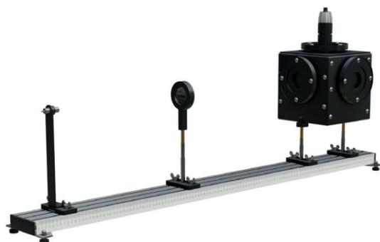
Установка предназначена для проведения лабораторных работ в вузе с задачей изучения интерференционной схемы колец Ньютона.
